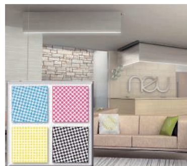
4 L'ottimo lavoro di pre stampa ha permesso conversioni a 6 colori, producendo un file Tiff 1 bit ben strutturato per la stampa con il retino concentrico.
